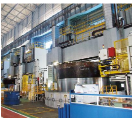
大型NC立旋盤 Large-Size NC Vertical Lathe
