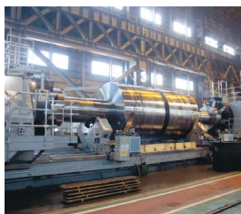
大型400トン旋盤 Large-Size 400-ton Lathe
