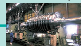
一体型低圧タービンロータシャフト Monoblock Low Pressure Turbine Rotor Shaft
