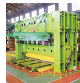
12,000トン 造管プレス 12,000-ton Pipe Forming Press
