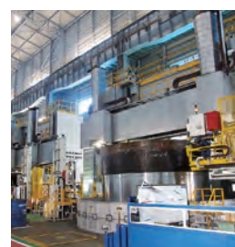
大型NC立旋盤 Large-Size NC Vertical Lathe
