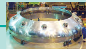
原子炉压力容器用下鏡リング Bottom Head Ring
