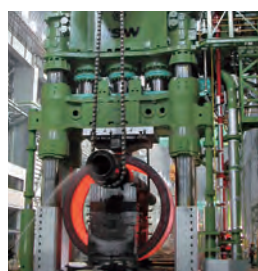
14,000トン 油圧プレス 14,000-ton Oil Hydraulic Forging Press
