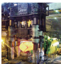
14,000トン 水圧プレス 14,000-ton Water Hydraulic Forging Press
