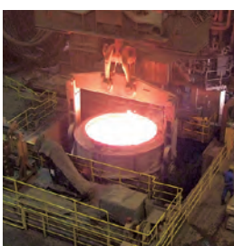
120トン ハイパワー電気炉 High-Power 120-ton Electric Arc Furnace
