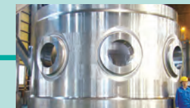
原子炉压力容器用シェルフランジ Nozzle Shell with Integral Flange
