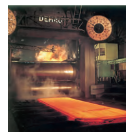
4重可逆式 広巾厚板圧延機 4-High Plate Mill
