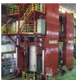
150トン エレクトロスラグ溶解炉 150-ton Electroslag Remelting Furnace
