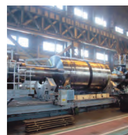
大型400トン旋盤 Large-Size 400-ton Lathe
